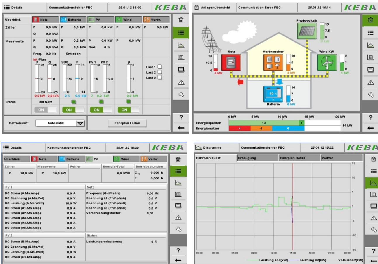
Abbildung 6: Darstellung der Visualisierung der Steuerung
